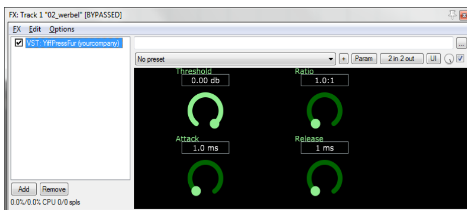
Rys. 4. Graficzny interfejs użytkownika kompresora, uruchomionego wewnątrz oprogramowania Cockos Reaper
